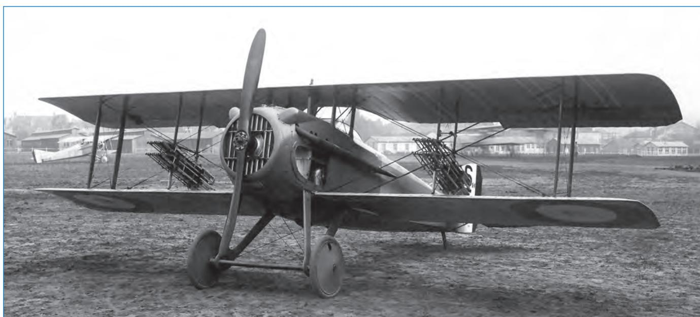
*Ce Spad VII à hélice Éclair du CRP 22 est équipé de pyrotorpilles de 75 entre les ailes à titre d'essai en octobre 1917 (Coll. Cony)*
