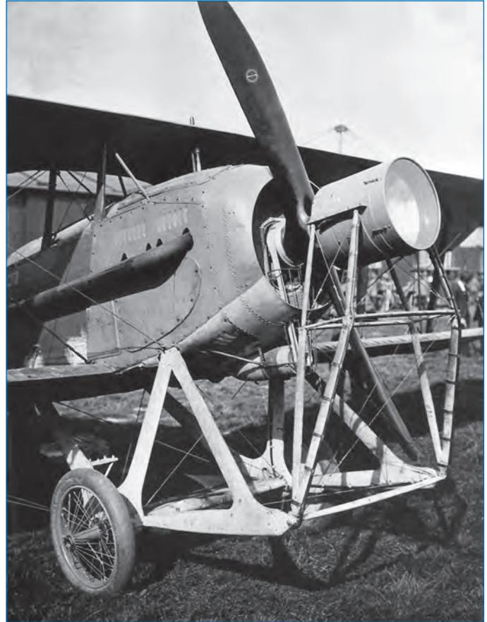
Étonnant modèle de Spad XI équipé d'un éclairage frontal pour le vol de nuit, avec un projecteur placé devant son hélice Éclair.
