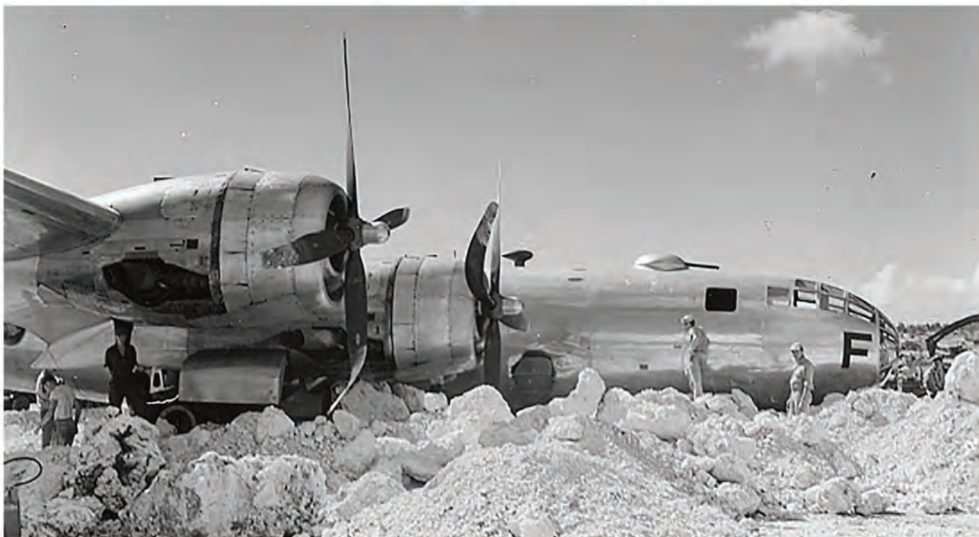
Le F13A s/n 42-93869 du 3 rd PRS après l'accident de décollage survenu à Guam-Harmon-Field le 26 avril 1945. En raison d'un fuselage déformé, il fut immédiatement rayé des listes (Written Off) pour devenir réserve de pièces. (USAF)
