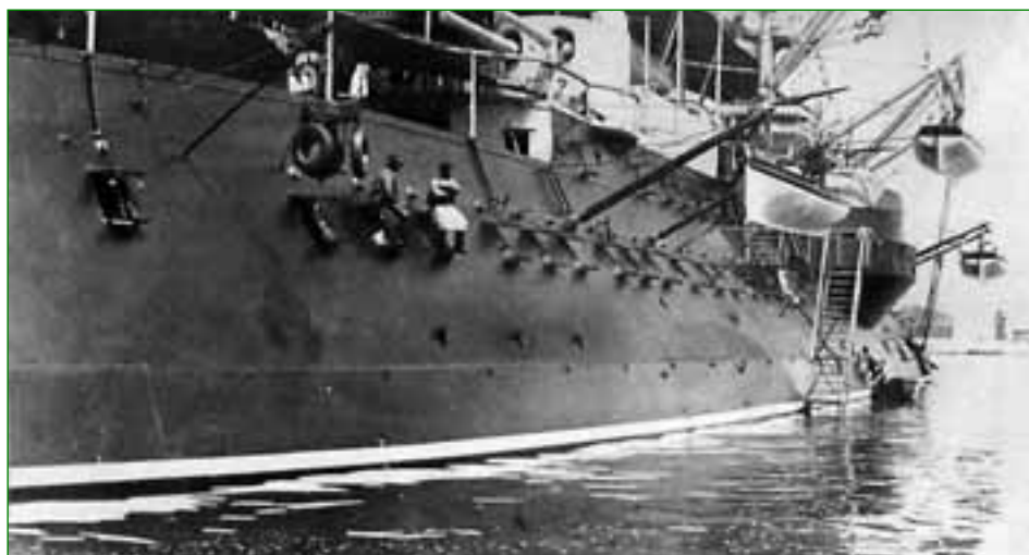
Le Jauréguiberry au mouillage en rade de Toulon. On note au premier plan à gauche, suspendu à un bossoir, un flotteur circulaire d'où pendent trois bouées couronne, engin de sauvetage dit grande bouée n° 1 (voir tome I, caractéristiques du cuirassé Charles Martel).
