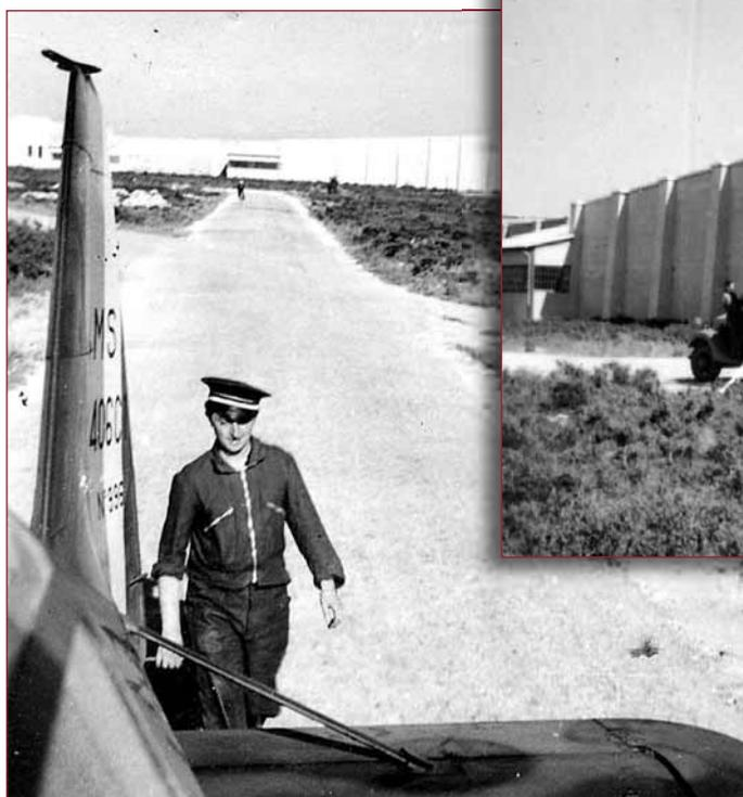
Sans butte de tir à Salon, les Morane doivent être envoyés à Istres pour le réglage des armes. Accrochés à un camion Matford, la béquille de queue soulagée par un chariot de manutention, les Morane 406 n° 348 puis n° 996 longent le stand de tir avant d'être placés au pas de tir. (photo Baudouin via SHD)
