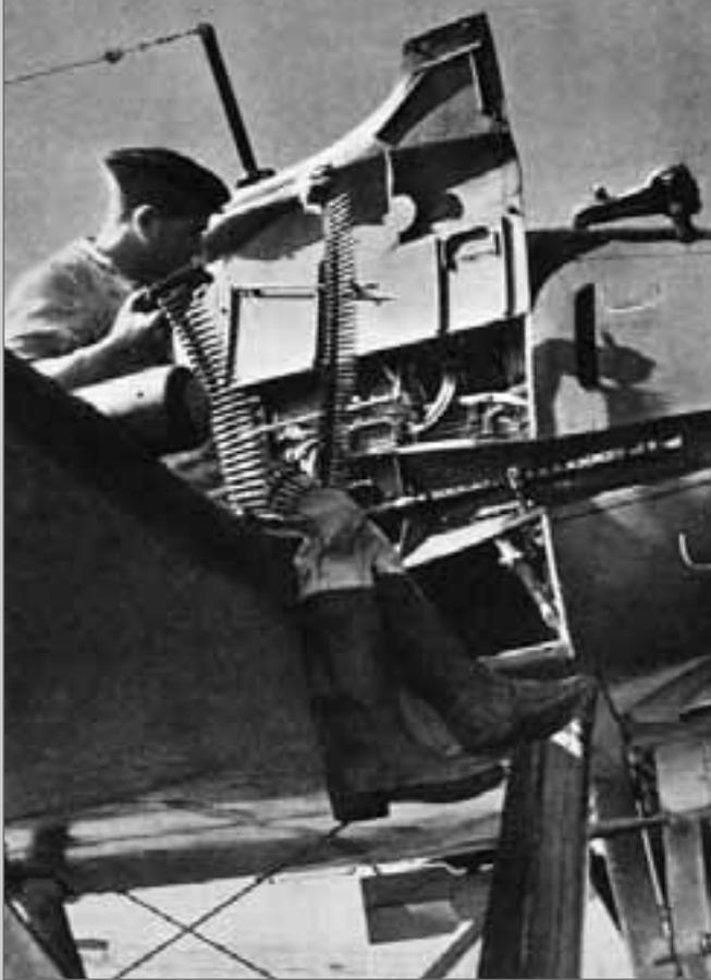
Approvisionnement en munitions de la mitrailleuse de fuselage.
