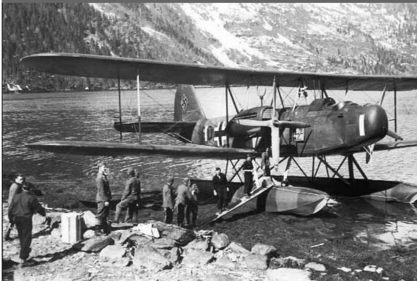
Superbe photo d'un He 59 D affecté au K.Gr.zb V. 108 pour les opérations de Norvège, en train de débarquer du ravitaillement dans un fjord norvégien en 1940. On remarque, sur cette version d'entraînement, la capote du poste de pilotage, pour l'entraînement au PSV, toujours en place.
