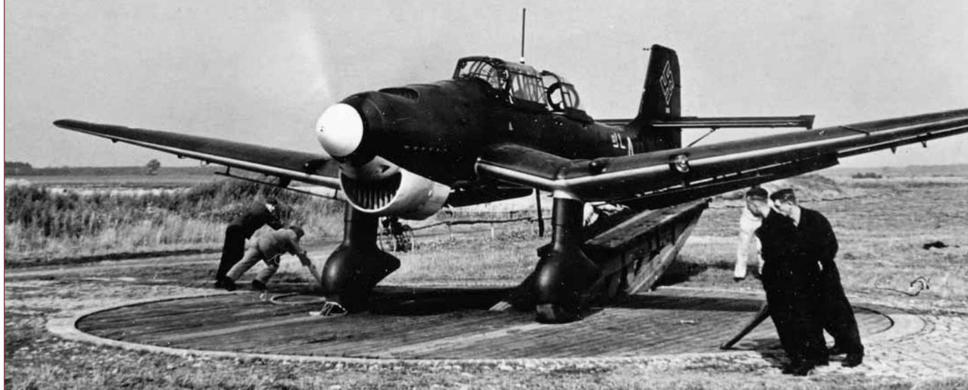
Vérification du compas d'un Ju 87 B-1 du IV.(St)/LG 1 à Barth. (AMC)
