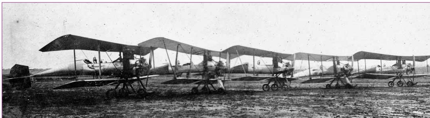
Alignement d'aéroplanes Type 1911 en sortie d'usine. On distingue des biplaces U1 à petites roues, et des U2 dont les roues sont plus fortes. La voilure présente deux baies complètes ou  $2\frac{1}{2}$ , ou  $1\frac{1}{2}$ . Bref il n'y en a pas deux identiques. (SHD/DAA B85-307)
