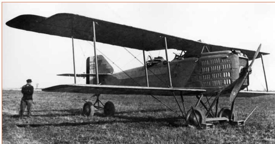
Sur le Breguet 17 la cheminée d'échappement traditionnelle fait place à un collecteur beaucoup moins encombrant, qui décharge à l'avant par un tuyau en crosse vers la droite. (P. Cortet)
