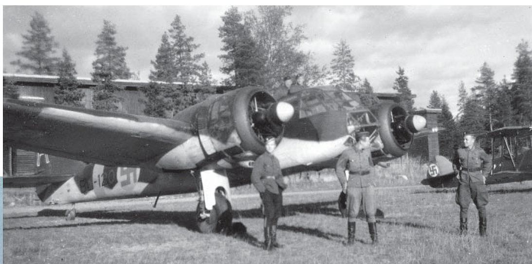
Atterrissage à Luonetjärvi le 31 mars 1944 du BL-111, un avion de l'escadrille d'entraînement T-LeLv17. On remarque les portes de la soute à bombes, cette dernière de type ouvert pour accommoder les bombes finlandaise.
