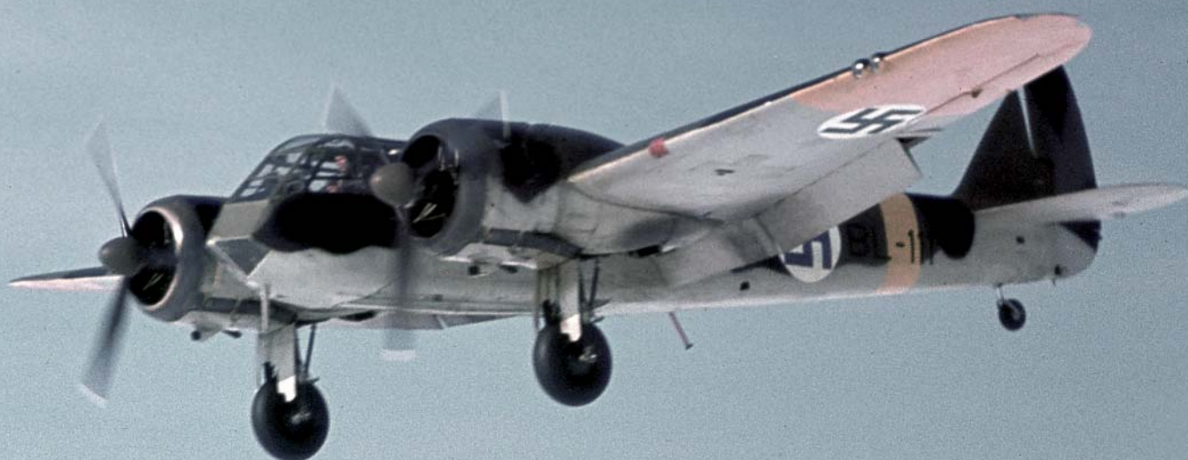
Atterrissage à Luonetjärvi le 31 mars 1944 du BL-111, un avion de l'escadrille d'entraînement T-LeLv17. On remarque les portes de la soute à bombes, cette dernière de type ouvert pour accommoder les bombes finlandaise.
