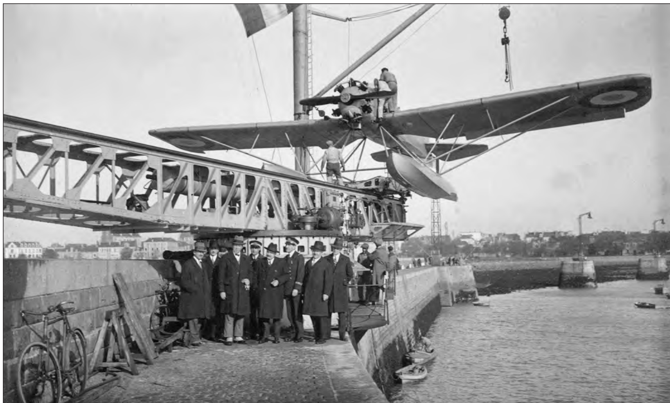
Le 30 octobre 1929, à Saint-Nazaire, on met en place un Gourdou-Leseurre GL.810 sur une catapulte de 3000 kg, destinée aux croiseurs de 10 000 tonnes. Au premier plan, parmi les officiels, les LV Pescher et Gizard, chargés des essais. (Collection Michel Ledet)
