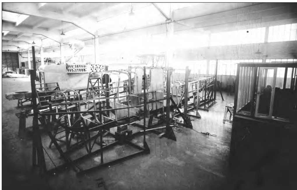
Construction du fuselage du Loire 130 n° 01 au printemps 1934, à l'usine d'aviation de Saint-Nazaire, des Ateliers et chantiers de la Loire. La structure, entièrement métallique, est bien visible sur ce cliché. (Association "Je me souviens")
