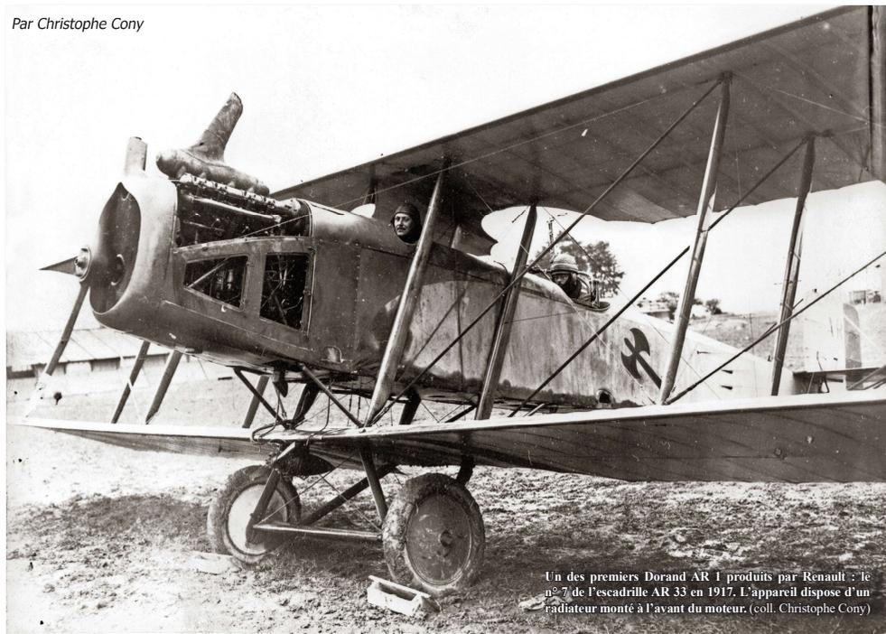
Un des premiers Dorand AR 1 produits par Renault : le n° 7 de l'escadrille AR 33 en 1917. L'appareil dispose d'un radiateur monté à l'avant du moteur. (coll. Christophe Cony)
