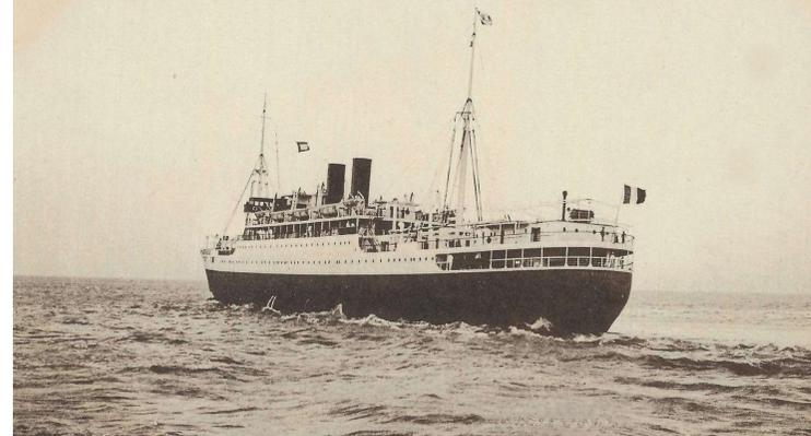
Carte postale du *Théophile Gautier*. Prototype des navires à moteur diesel des Messageries Maritimes (un MS et non pas SS comme indiqué). Paquebot de 8 200 tonnes, construit en 1927 par les ACF. Coulé en 1941 en mer Egée par un sous-marin britannique. Son aspect reste conventionnel avec 2 grandes cheminées. (DR; collection AS)
