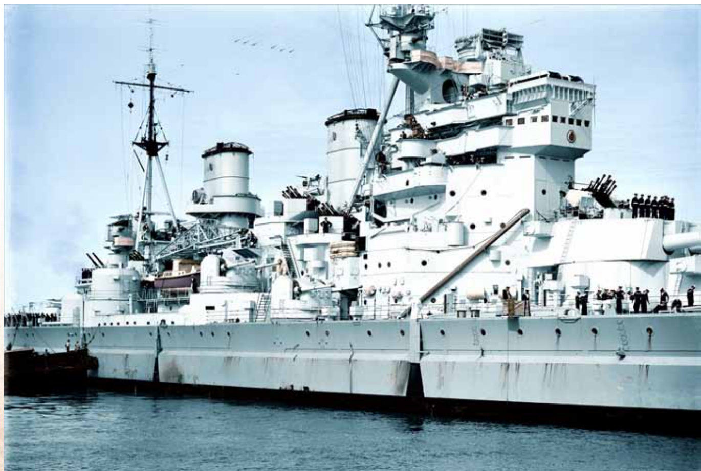
Les superstructures avant du King George V. Au sommet la plate-forme des compas supportant le télépoteur principal, en dessous l'abri de navigation et plus bas les meurtrières du blockhaus.
