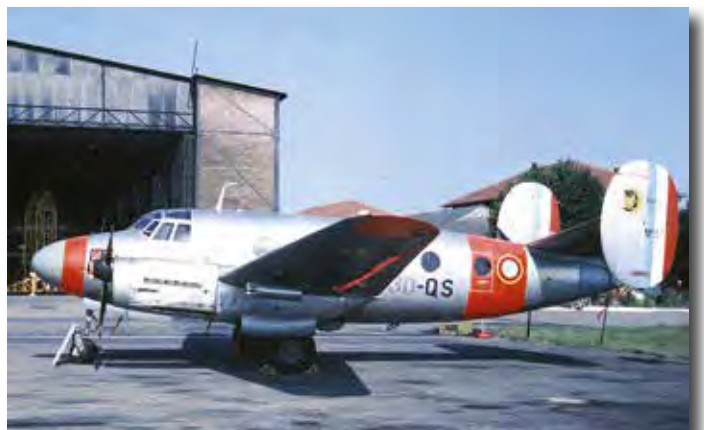
Le Flamant MD-315 « Radar » n° 51 codé 30-QS en juin 1970 de l'EETT 12/30 « Hautvillers » de Reims, qui arbore sur le nez l'insigne officiel de l'escadron, et sur la dérive l'insigne de l'unité, hérité du CIPN de Tours. Il est équipé du radar DRAC 25 logé dans le nez proéminent. On notera la présence sous l'aile d'un panier Matra LR122 à roquettes SNEB de 68 mm © coll. J. Guillem
