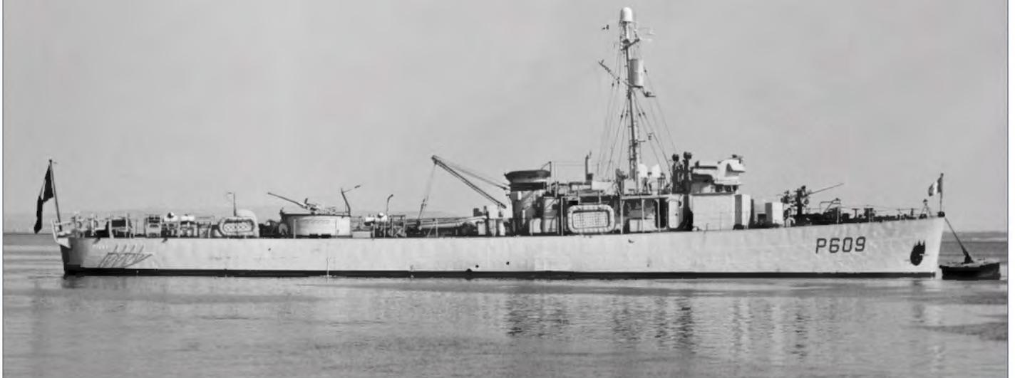
La *Pique* début 1954, vue par le travers, sur coffre à Bizerte; les PC sont des unités dont le pont principal est continu d'un bout à l'autre du navire, « Flush deck » selon la terminologie anglo-saxonne (Photo DCN Bizerte - Coll. Pradignac & Leo)
