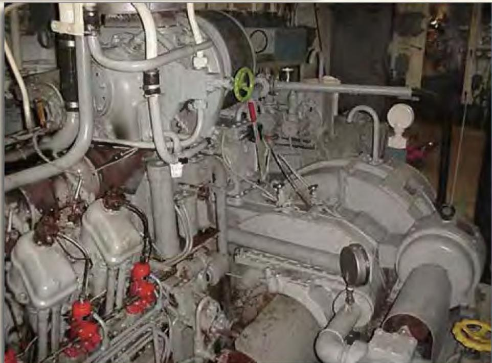
Propulsion : moteur SEMT Pielstick, turbocompresseur Brown Boveri et réducteur sur *Le Fougueux*
