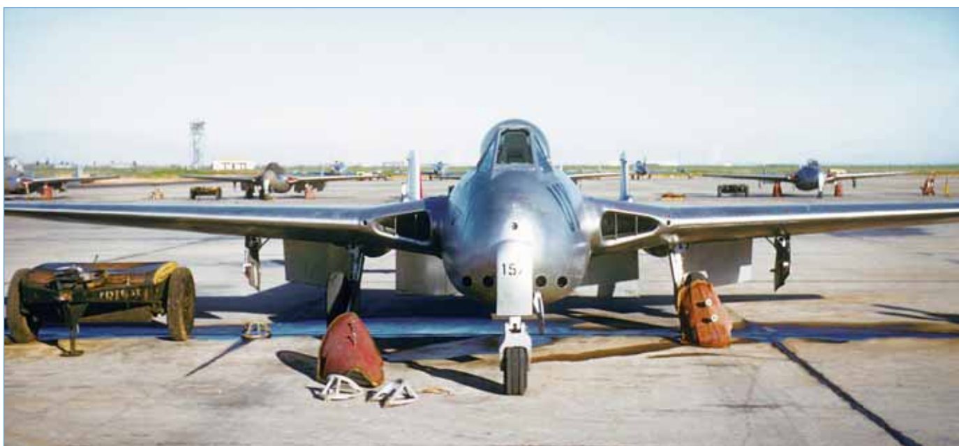
Le 10157 UY. Noter les protections des entrées d'air déposées. (Photo M. Blanc)
