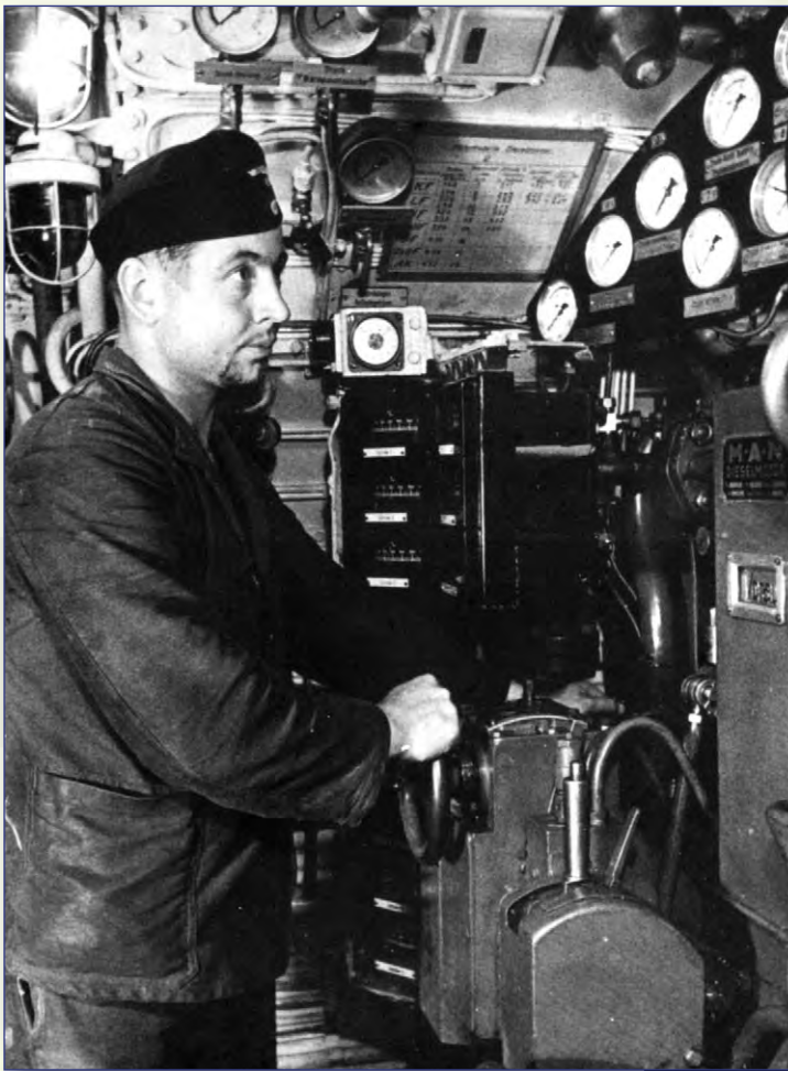
La salle des diesels à bord de l' U.65 , un type IXB. Le marin pose pour le photographe. D'après les voyants, les deux moteurs sont à l'arrêt. (Bundesarchiv)
