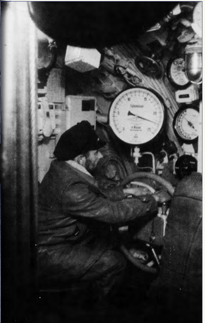
La "Zentrale" de l' U.98 où l'on voit les marins chargés des hydroplanes avant (à gauche) et arrière (à droite). Le grand cadran indique que le sous-marin se trouve à 23 m de profondeur. (ECPAD)
