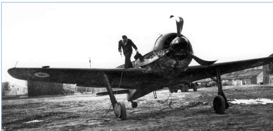
Après l'accident, l'avion fut ramené devant les ateliers du "Neu-Neu". Le train fonctionnait encore malgré l'atterrissage sur le ventre. L'avion est bien un type A8 équipé de son aile d'origine vu la position du Pitot en extrémité de l'aile droite. (coll. J-Y Lorant)
