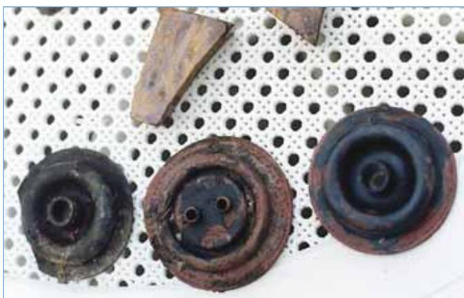
Pièces en caoutchouc servant à protéger les câbles de commande au passage d'une cloison dans la cellule d'un FW 190. Trouvées aussi à même le sol dans les années quatre-vingt, ce dernier étant depuis nettoyé! (photo Ph. Couderchon)
