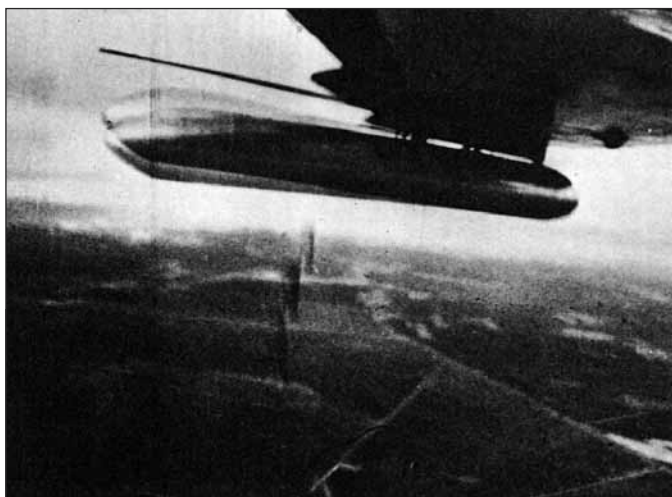
Fin 1964 début 1965, E IV P n° 103, expérimentation au CEV du tir de cartouches photo éclair. On voit le départ intempestif de trois cartouches. Noter aussi la vibration du conteneur due au largage. (MN)
