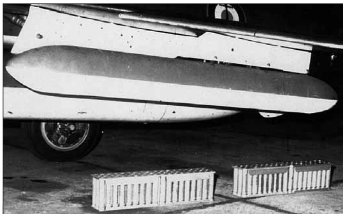
Le conteneur en version avec 104 cartouches de 40 mm. (MN)
