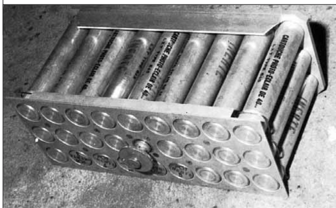
Le chargeur de 26 cartouches de 40 mm, avec sa poignée de verrouillage. (MN)
