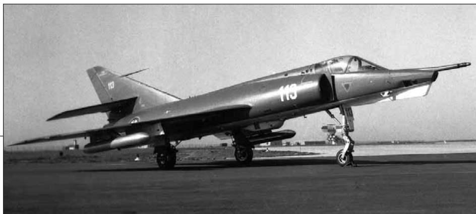
Au premier semestre 1967, l'Étendard IV P n° 113 sert à valider les essais de photo de nuit. Il est ici équipé de deux conteneurs lance-cartouches LC III. (DR)
