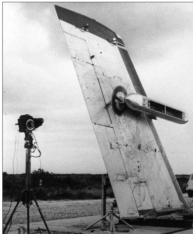
Essais au sol du lance-cartouches Alkan sur un élément de voilure de prototype, fin 1965. Vue d'ensemble de l'installation. (DR)
