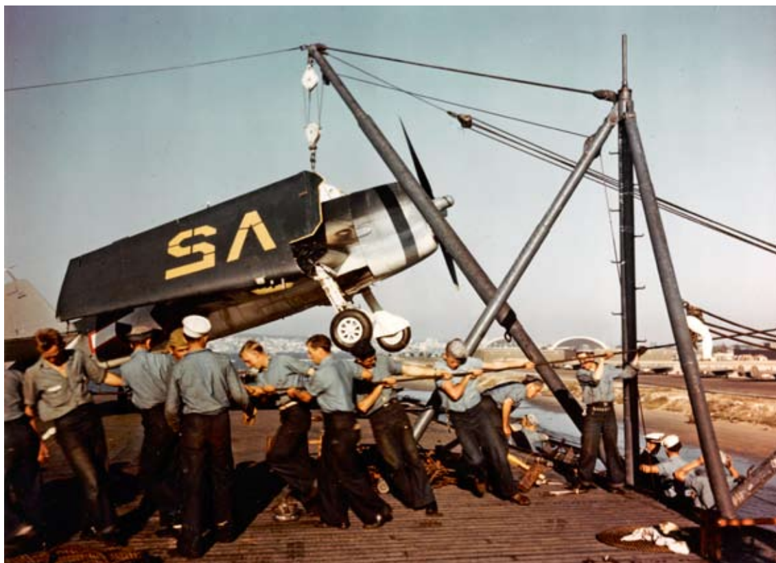
Pris sur les docks de la base navale de San Diego vers la mi-1943, ce cliché montre des marins en train de hisser un F6F-3 à bord d'un porte-avions. On voit bien que lorsque les ailes se replient, c'est leur surface supérieure qui vient « basculer » le long du fuselage.
