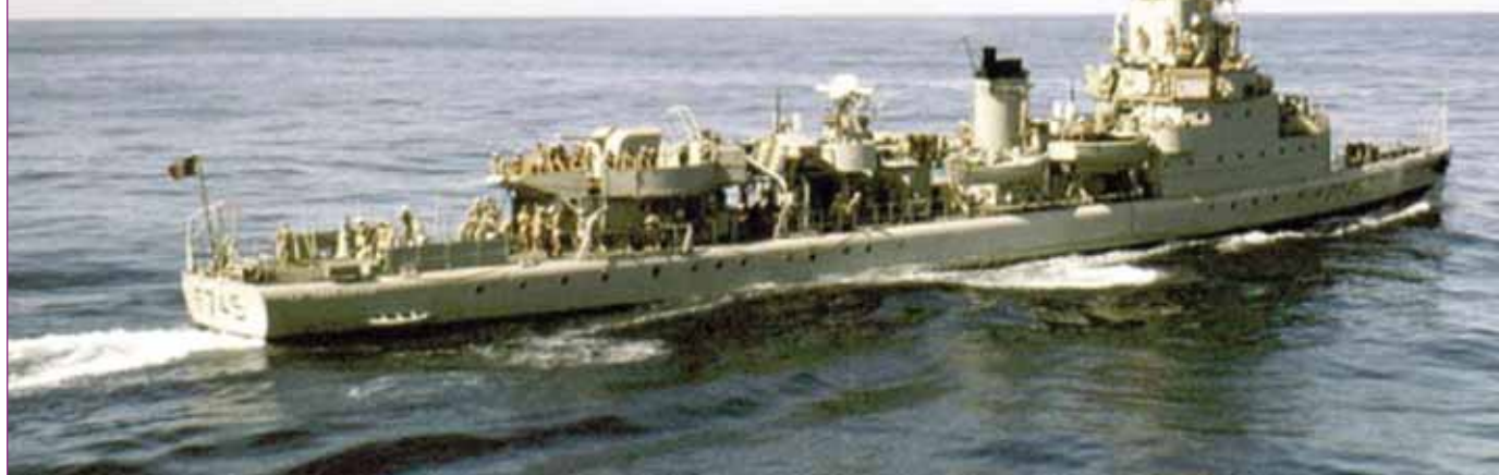
Ces deux photos montrent La Capricieuse à la mer avec de la houle. Elle a troqué son radar cloche SL en tête de mât pour un radar aérien avec antenne tournante.
