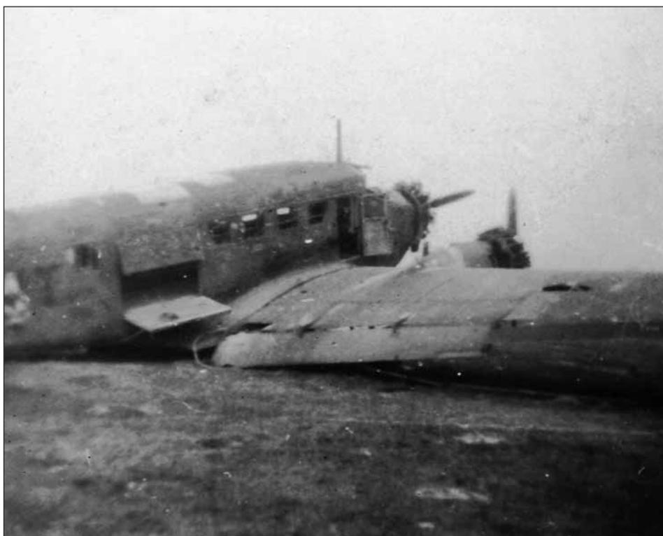
**Les 5 photos suivantes:** Le Junkers va maintenant être complètement démonté en commençant par les trois moteurs. Pour certaines étapes comme le démontage des ailes, des outils spéciaux devront être fabriqués, plutôt que de chercher, certainement en vain, les outils d'époque.
