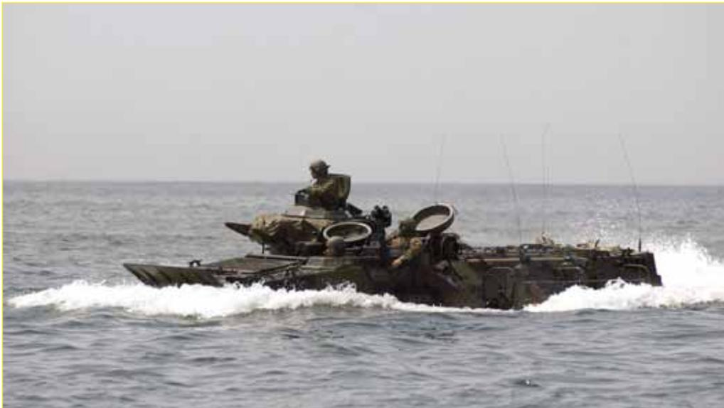
Véritable blindé amphibie, l'AAV a la capacité d'embarquer une vingtaine de marines et de les déposer en toute sécurité au-delà de la plage.
