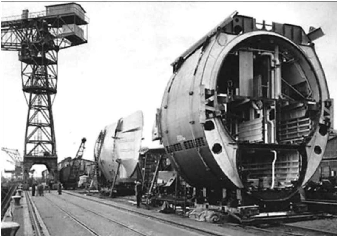
Plusieurs sections d'un type XXI en attente d'assemblage. (IWM)
