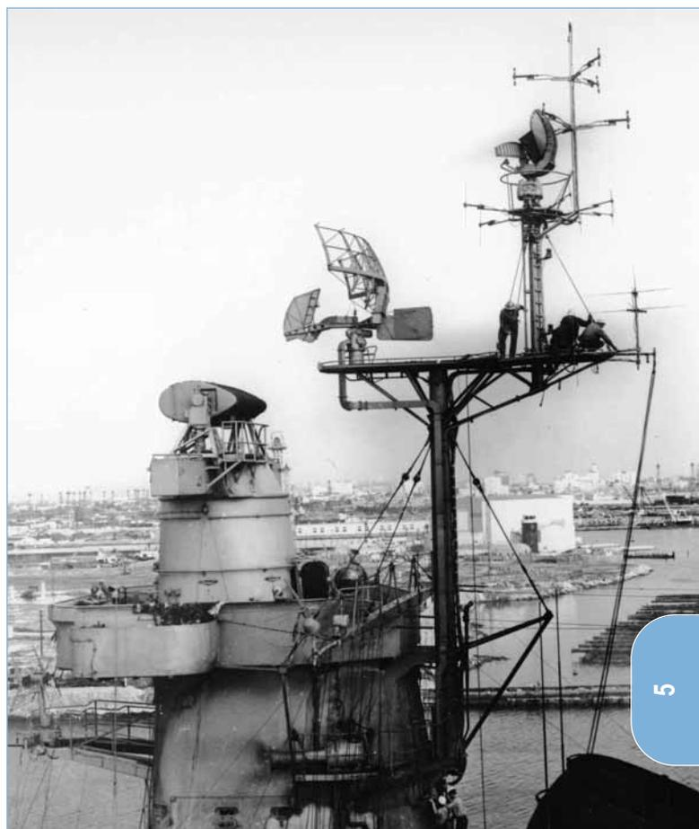
La mâture avant de l'*Iowa* en janvier 1952. Au plus haut l'antenne radar SPS 6, un peu plus bas, en avant l'antenne du SPS 12 et sur le télémètre principal l'antenne Mk-13. (National Archives)
