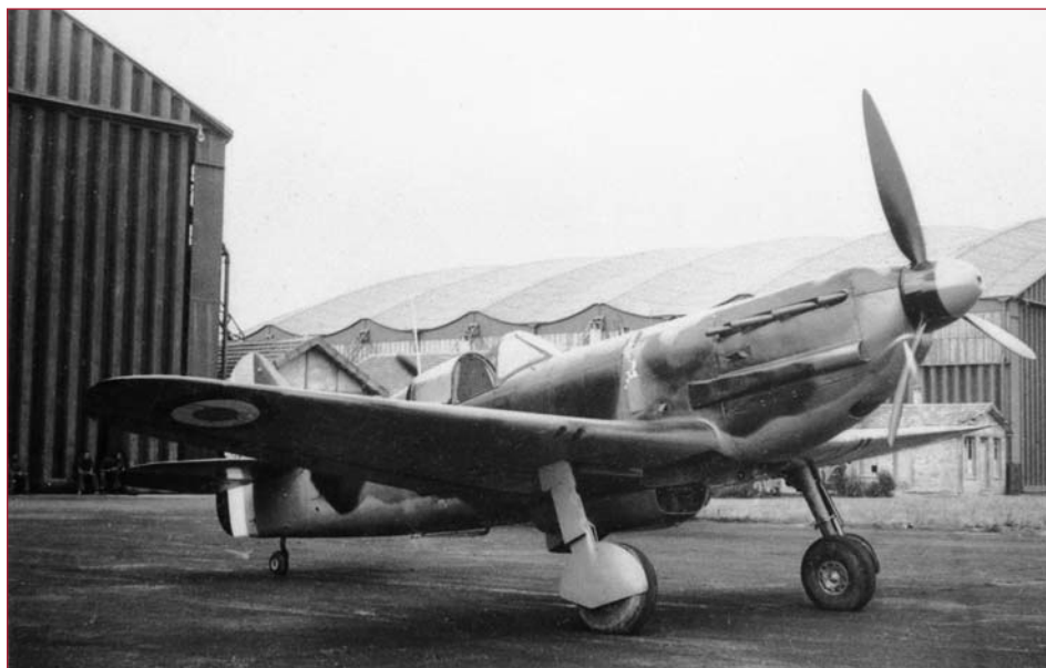
Le même D.520 (voir page précédente) de l'état-major du groupe vu du côté droit (n° 184). Cet avion est équipé des échappements "pipes quatre corps", conçus par le bureau d'études d'Émile Dewoitine. Ces échappements à effet propulsif avaient été étudiés pour le D.513 et n'équipèrent qu'un tout petit nombre de D.520. (photo origine Violet)
