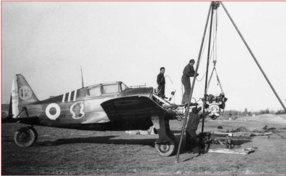
Le moteur est en train d'être hissé avec un palan à chaîne installé en haut d'une chèvre. Sur le fuselage seul le blanc de la cocarde a été peint (MS 406 n°231). Le petit chariot sur lequel repose la bécaille était appelé un "BO" par les mécaniciens. (photo René Challe)
