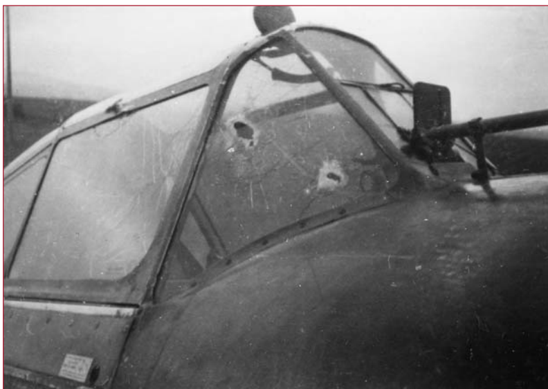
Impacts de balles dans le pare-brise du Morane de l'Adj Littolff après le combat du 22 novembre 1939 contre des Messerschmitt 109. Cette vue permet de voir plusieurs détails intéressants comme le rétroviseur en position relevée, la glace teintée en vert foncée du collimateur en avant du pare-brise ou la petite plaque métallique qui indique comment ouvrir la verrière depuis l'extérieur en utilisant la petite manivelle qui se rangeait à l'intérieur du raccordement de l'aile gauche. (photo Adonis Moulène)
