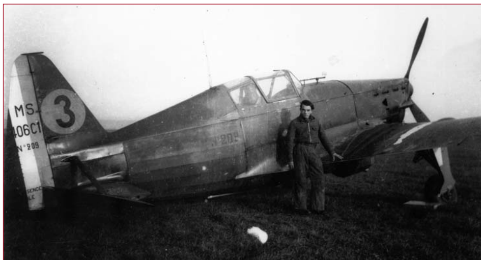
Le Sgt Gontran Cahen était aux commandes de ce Morane le 9 décembre 1939 quand la carène de raccordement d'aile (raccord Karman) fut arrachée au cours d'un piqué. Cet avion était le Morane habituel du S/Lt Jacquin (MS.406 n° 209, codé 3). (photo François Pilatre-Jacquin)
