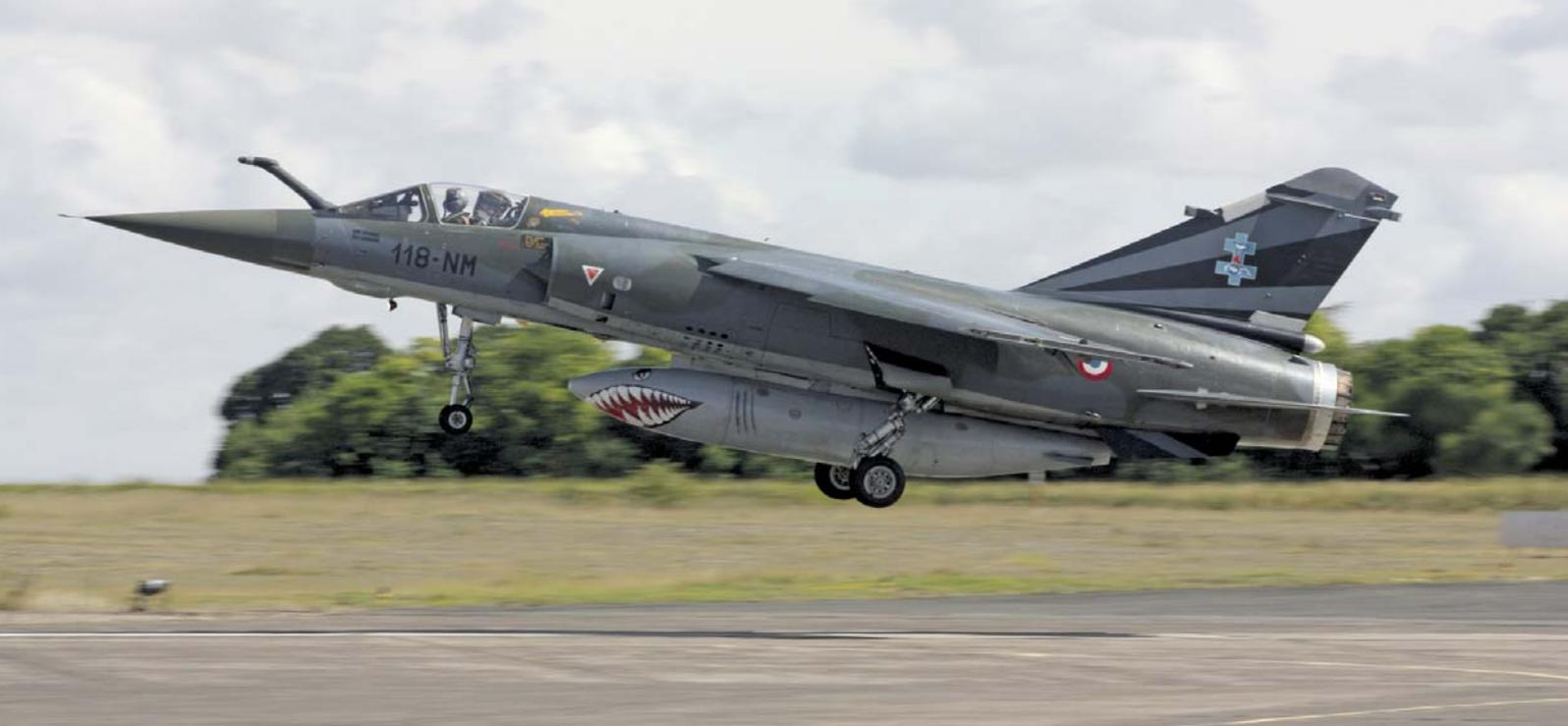
**14 juillet 2014 : le Mirage F1 du Cdt Leprince immortalisé quelques secondes avant son touché des roues, équipé du bidon de 2200 litres qui a une garde au sol de seulement huit centimètres.**
