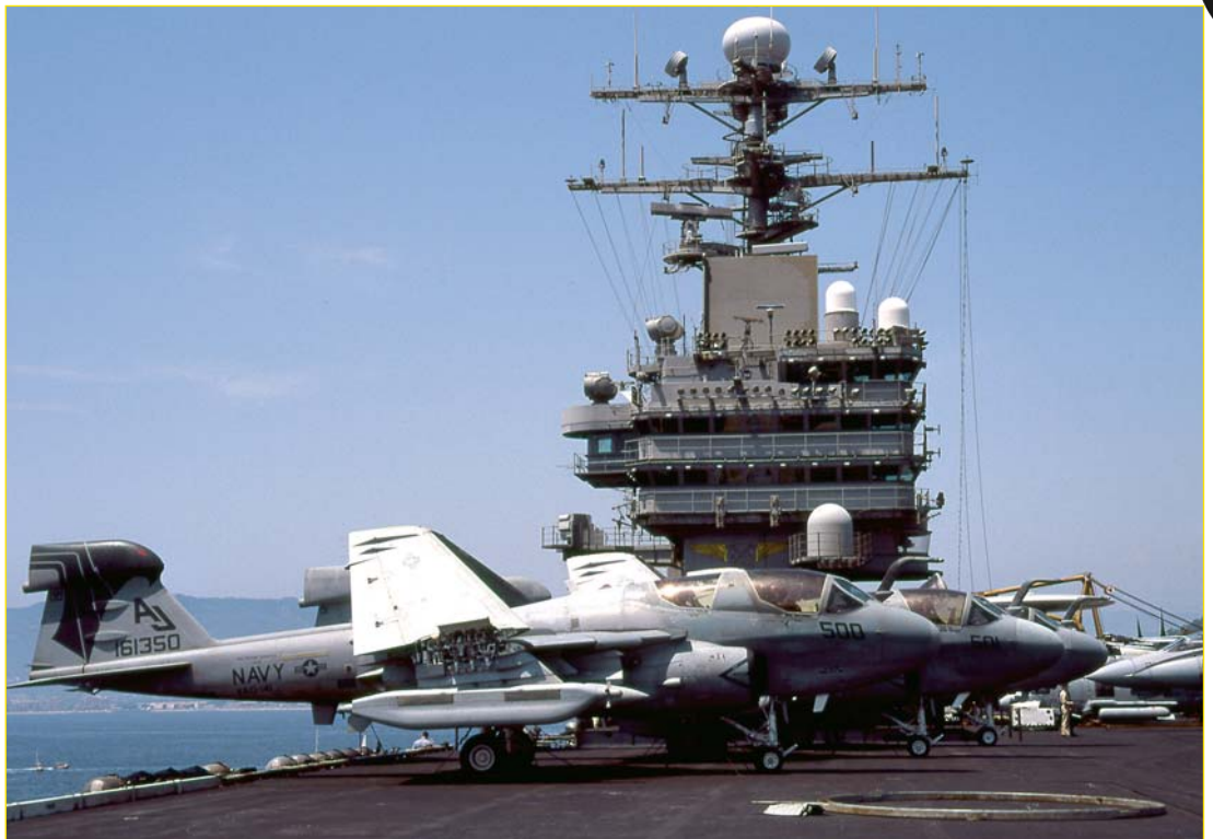
L'îlot du Roosevelt en escale à Cannes en juillet 1999. Au sommet du mât, la grande sphère blanche abrite le SatCom WSC-6 du Defense Satellite Communication System . Au premier plan, un EA-6B Prowler de guerre électronique de la VAQ-141. (Jean-Marie Krausener)
