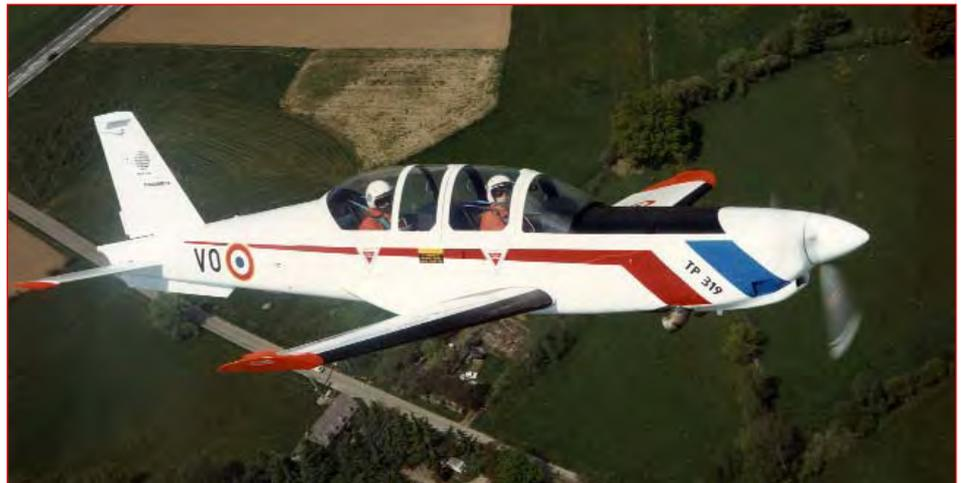
Le prototype de l'Epsilon a été remotorisé avec une turbine TP 319. (Cl. Lherbet)
