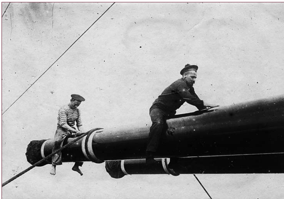
Des marins entretiennent les pièces de 305 mm à bord du Gaulois .
