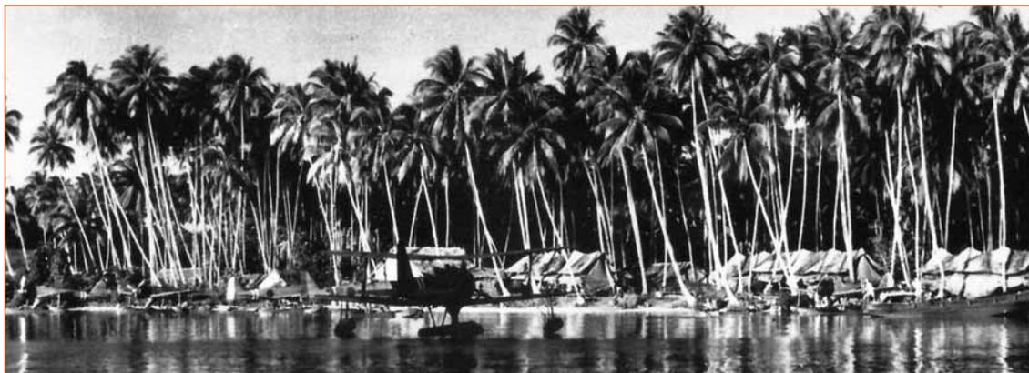
Le groupe aérien du *Kamikawa Maru* à Faisi. On compte, au mouillage, un F1M2 et cinq A6M2-N dont les quatre, à gauche du biplan, sont respectivement codés (de gauche à droite) YII-104, YII-103, YII-107 et YII-108. On note que celui sur la droite du cliché et dont le code n'est pas visible est décapoté et aux mains des mécaniciens.
