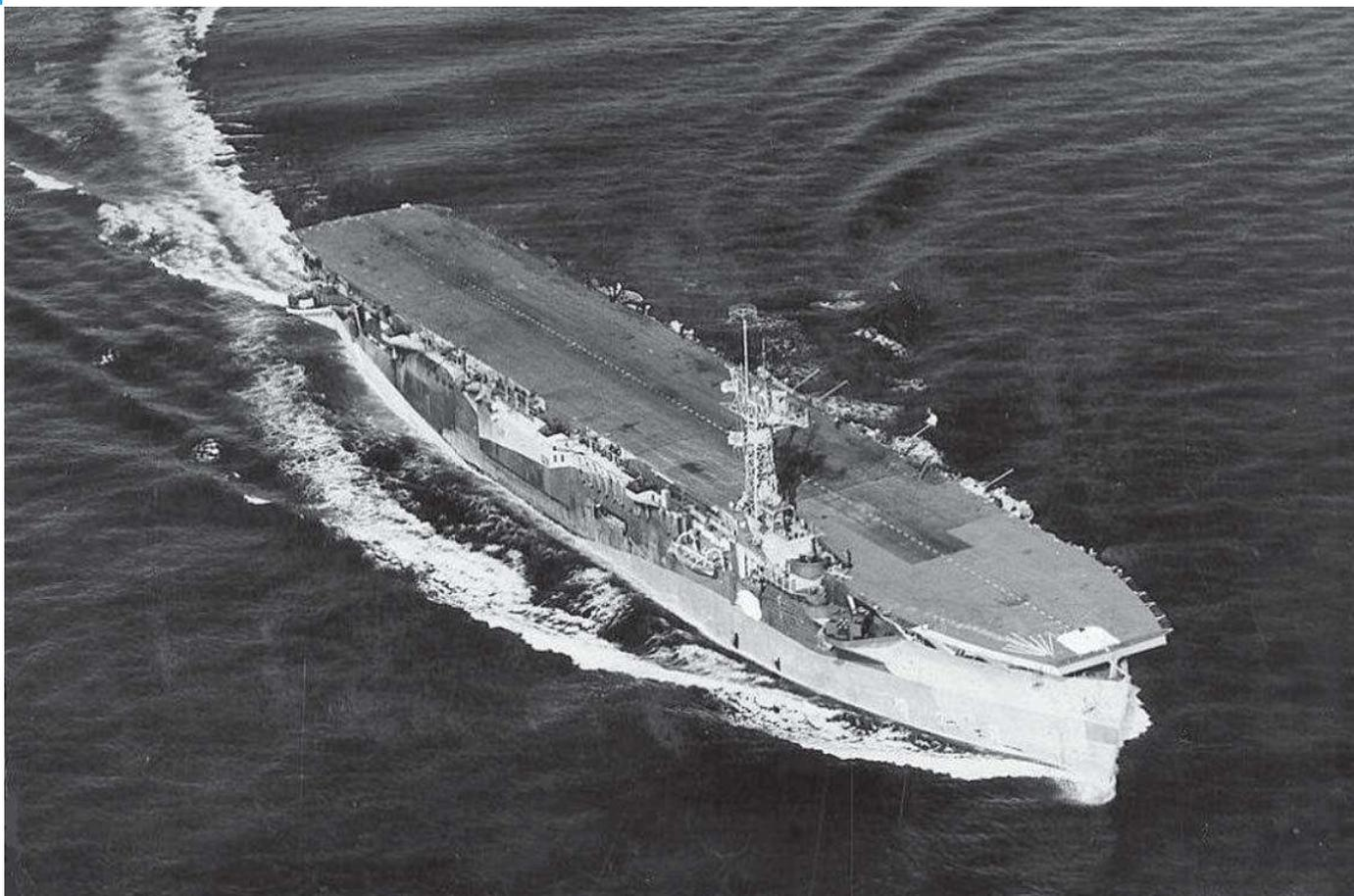
Pouvant transporter dix-huit avions et bien armé avec deux canons AA de 102 mm/45, quatre affûts quadruples de 40 mm et seize canons de 20 mm, le porte-avions d'escorte *HMS Campania*, comme tous ses congénères, demeure un adversaire redoutable contre les *U-boote* et les attaques de la *Luftwaffe* lorsqu'il est incorporé à la défense des convois. (DR)
