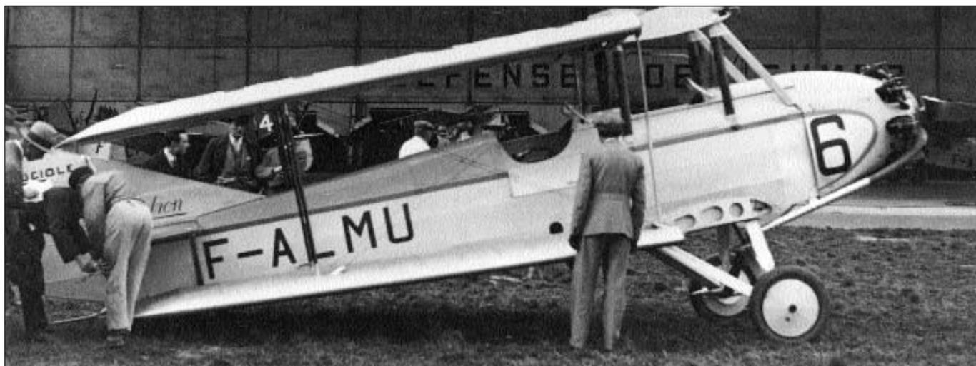
C.270 n/c 6/6567 F-ALMU à moteur Salmson de 95 ch, devenu C.272 n/c 25/6567 à moteur Renault de 95 ch.
