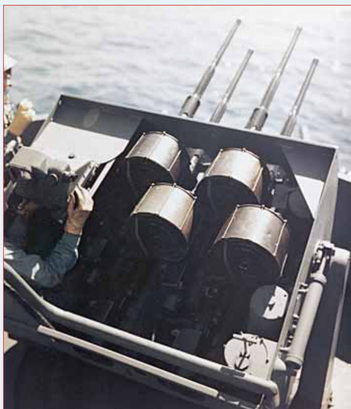
Un montage expérimental de quatre canons de 20 mm, baptisé Thunderbolt, fut installé sur le cuirassé West Virginia en 1945 ; il ne donna pas entière satisfaction à cause de son calibre trop faible. (NARA)
