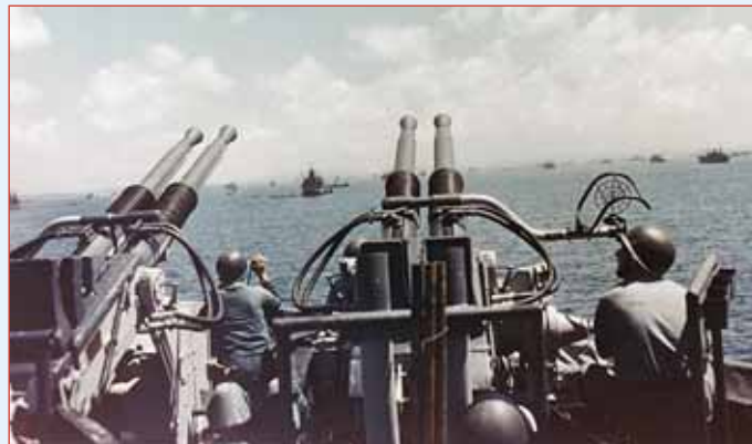
La plus efficace des armes antiaériennes contre les kamikazes était le canon Bofors de 40 mm, ici sur affût quadruple Mk 12 installé sur le cuirassé USS West Virginia , photographié lors des combats d'Okinawa en 1945. (NARA)
