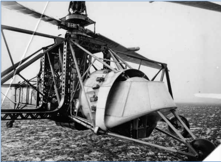
Le moteur en étoile Hispano, refroidi par air nécessitait un ventilateur installé à l'avant sous un capot particulier. (MAE)
