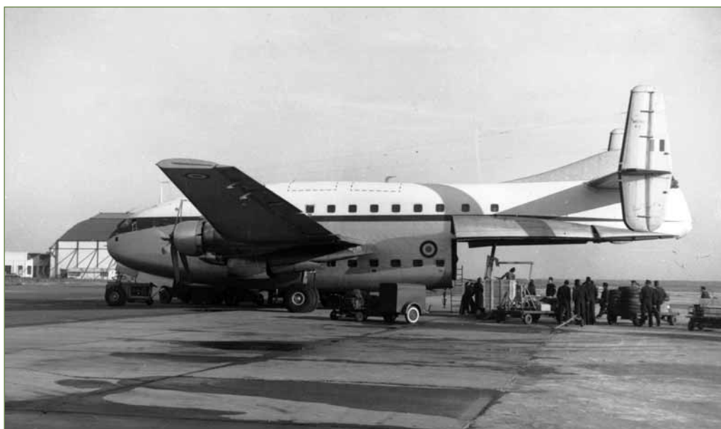
À Cazaux en novembre 1959 on charge le 765 n° 2. Noter sous l'arrière de la soute la béquille anti-basculement. (Chenel)
