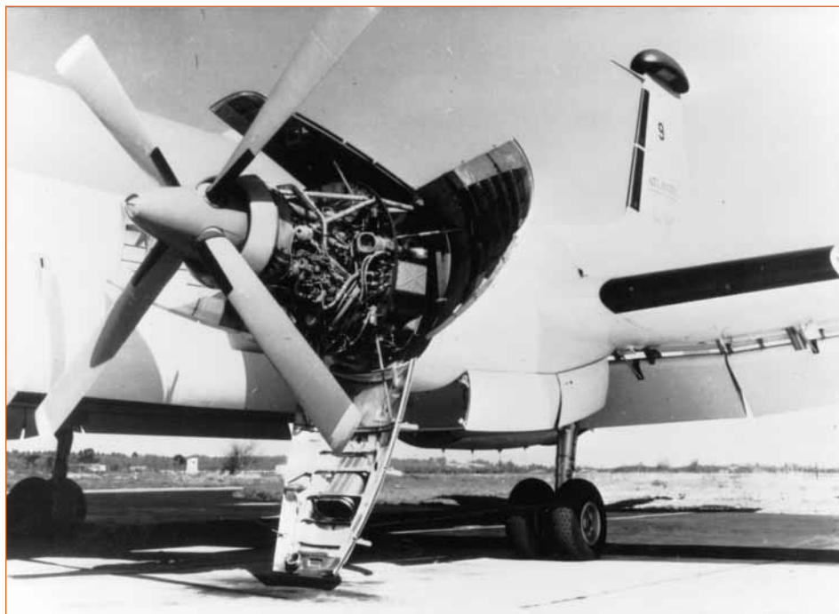
Les capots des turbopropulseurs Tyne s'ouvrent en 4 pétales. (Aviaplans/Dassault)
