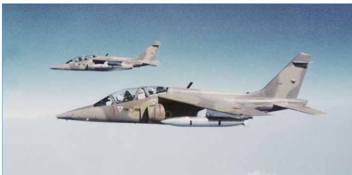
Une paire d'Alphajet camerounais. Le nez possède la fenêtre laser, mais la gouttière dorsale "africaine" n'est pas de mise. (P. Cortet)
