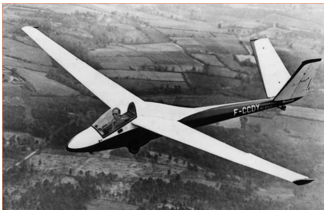
Le prototype du Breguet 905 se distingue par des tabs commandés sur l'empennage. (MA 15929 © MAE)
