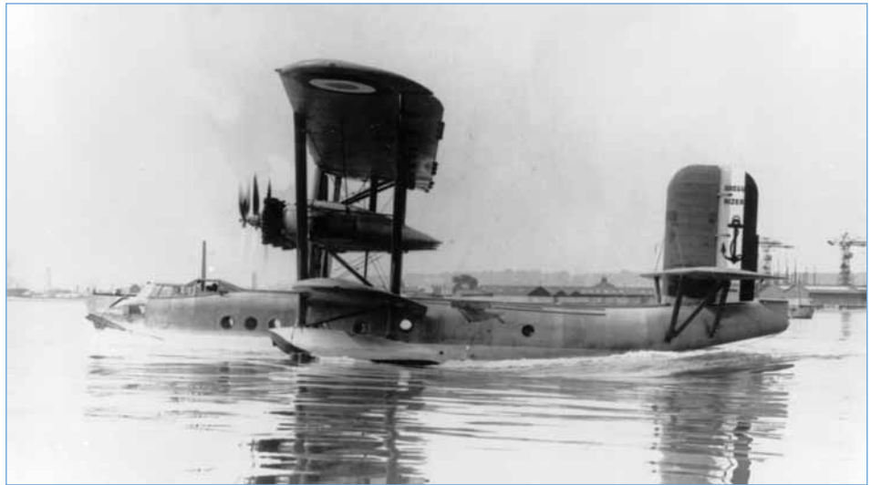
Pour ses premiers essais le Bizerte n° 1 n'a pas encore de capotage des moteurs, (P. Cortet)
