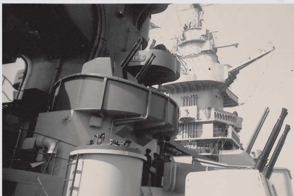
Une partie de l'armement anti-aérien du cuirassé avec au premier plan un télépointeur pour 40 mm. (DR)
