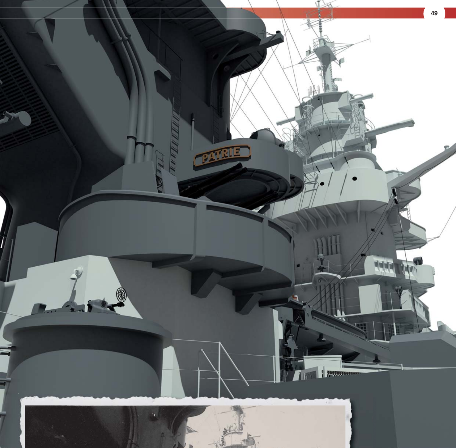
Une partie de l'armement anti-aérien du cuirassé avec au premier plan un télépointeur pour 40 mm. (DR)
