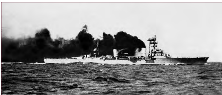
Essais à la mer de marche à grande vitesse, avec panache de fumée pour masquer éventuellement d'autres navires au combat.
